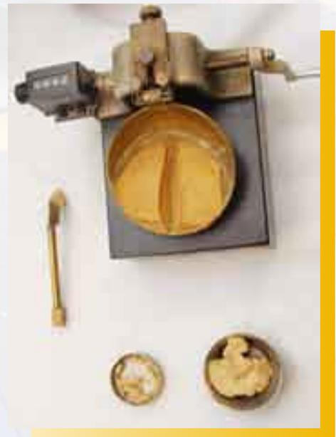
En el Laboratorio de Geotecnia, donde se realizan estudios de los suelos y las rocas desde el punto de vista físico y mecánico, se mide la plasticidad del suelo.
