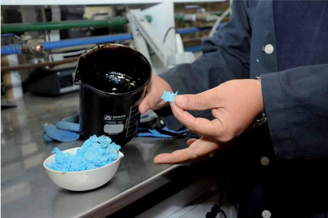
La bolsa no puede mezclarse entera con el asfalto, debe ser descuartizada con una guillotina para evitar que se forme una capa dura que no permite una fusión óptima (foto Jorge Carvajal).
