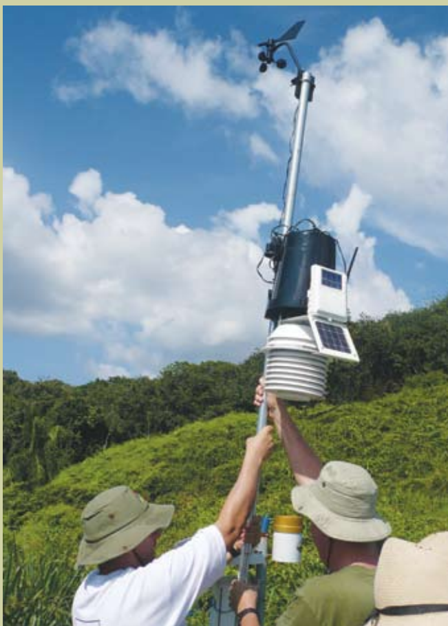
Esta estación meteorológica automática fue instalada cerca de Bahía Chathan, en la isla del Coco, para medir distintas variables atmosféricas como viento, temperatura y precipitación (foto Jeffrey Sibaja).
