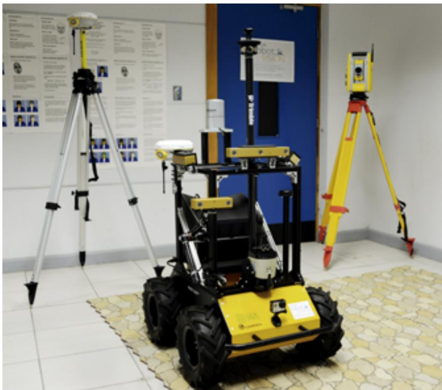
El Robot Vision, junto al GPS RTK (izq.) y la Estación total robótica (der.), componen el equipo con el cual se prueba el Algoritmo de dometría visual monocular desarrollado en el IPCV-LAB de la UCR (foto Laura Rodríguez).
