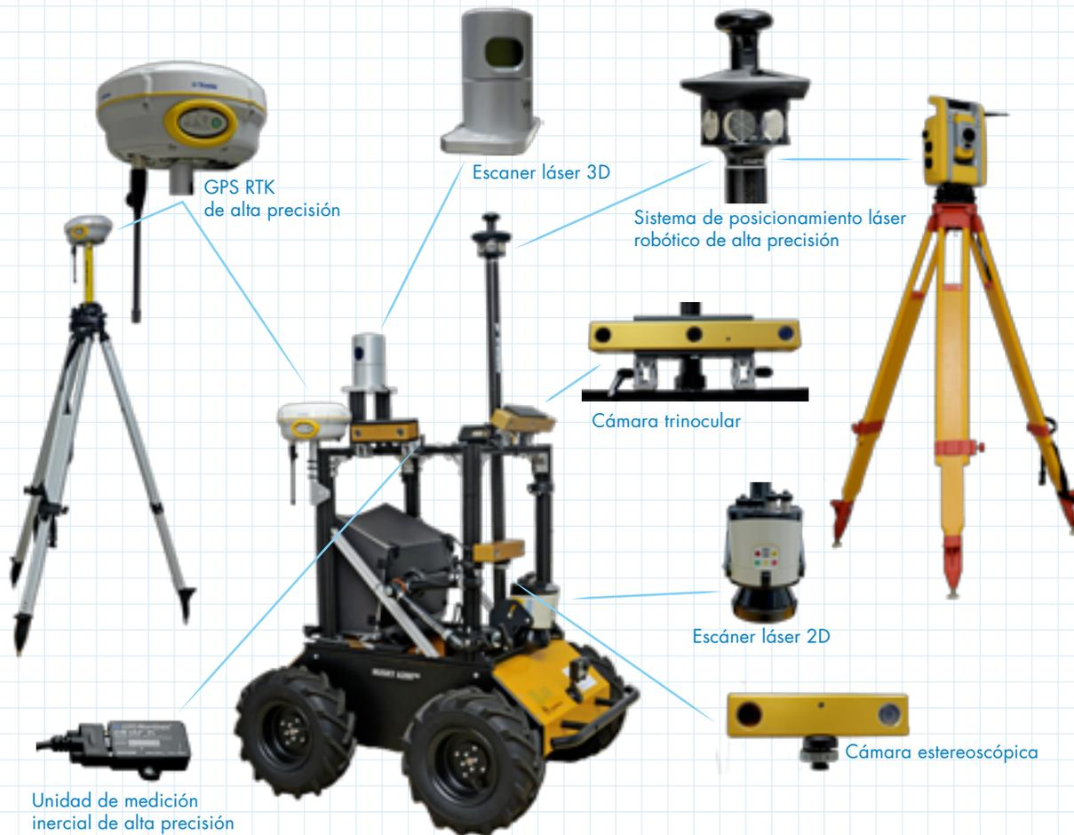
El algoritmo desarrollado en el laboratorio de la Escuela de Ingeniería Eléctrica de la UCR es un software que tiene que ser evaluado en un robot tipo Rover, como el que se muestra en la gráfica, para constatar su eficiencia. También se describen cada uno de los sistemas que se utilizan para probar el algoritmo (infografía Rafael Espinoza).
